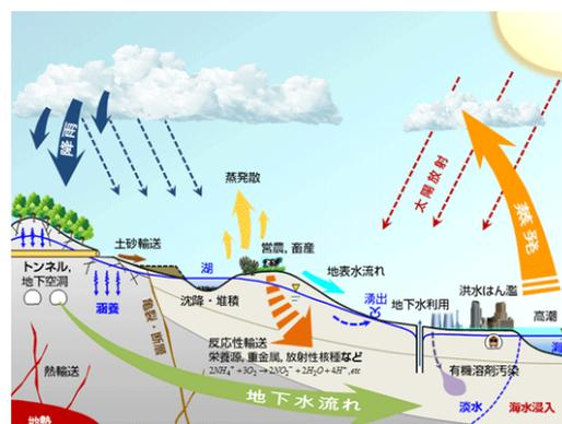
従来では地下水の流れを見るためには、地上から地下にいくつかの孔を掘り、地下水の流れを実測しながらモニタリングするしか方法がなかったが、近年、地圏環境テクノロジーが、陸域における水循環システ
